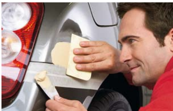
Punktgenau Schäden ausbessern: mit Smart-Repair.
