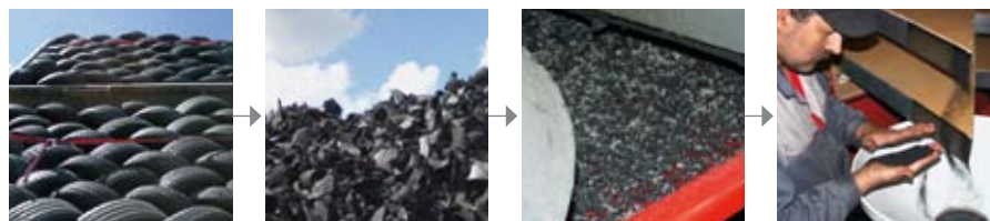
Über 10 Millionen Reifen recycelt A.T.U im Jahr. Der Prozess reicht vom Zerreißen der Reifen in grobe Stücke über die Zerkleinerung des Reifengummis bis hin zur Trennung verschiedener Materialien.
