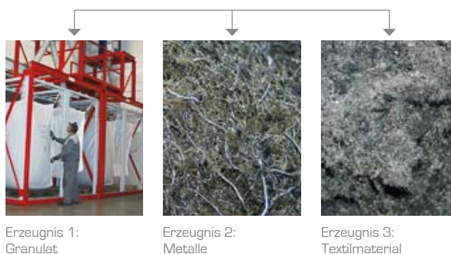
Über 10 Millionen Reifen recycelt A.T.U im Jahr. Der Prozess reicht vom Zerreißen der Reifen in grobe Stücke über die Zerkleinerung des Reifengummis bis hin zur Trennung verschiedener Materialien.
